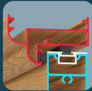
Mayor Hermeticidad y Aislamiento entre Batiente y Cabezal por sus Dos Felpas
