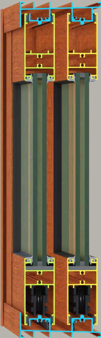
Mejor Salida de Agua por: - Riel con Pared Interior Alta - Inclinación de Riel - Drenes Inferiores
