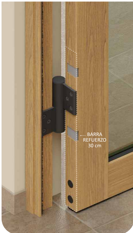
Instalación de Bisagra Inferior
