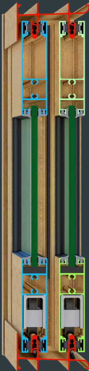
Mejor Salida de Agua por: - Riel con Pared Interior Alta - Inclínación de Riel - Drenes Inferiores
